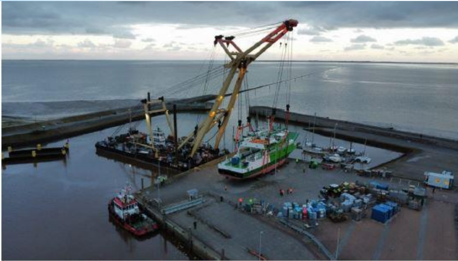
Beispiel Anlandung mit Schwimmkran Enak (Quelle: Quelle: Homepage des Schiffseigners)
